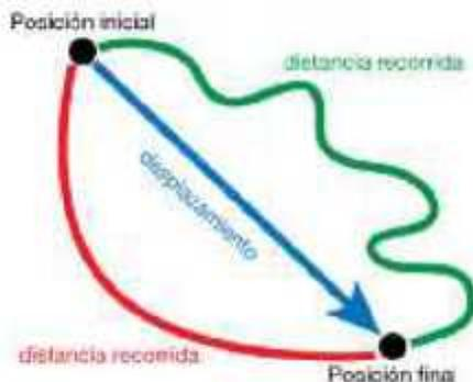
**Vector:** segmento orientado que indica la dirección, el sentido y el valor del desplazamiento
