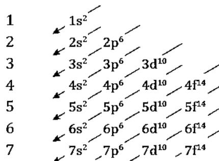
Una forma sencilla de obtener la configuración electrónica de un elemento, es mediante la utilización del Diagrama de Möller o Regla de las Diagonales.
