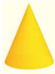
2. **Cono:** se genera con la rotación de un triángulo rectángulo sobre uno de sus lados
