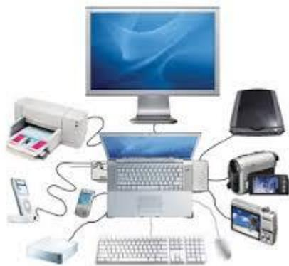
Los dispositivos o periféricos de un computador, son todos aquellos componentes que permiten ingresar o extraer información del mismo. El papel que juegan los dispositivos de la computadora es esencial; sin tales dispositivos ésta no sería totalmente útil. A través de los dispositivos periféricos podemos introducir datos que nos sean útiles para la resolución de algún problema y por consiguiente obtener el resultado de dichas operaciones, es decir; poder comunicarnos con la computadora.
