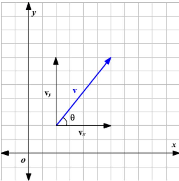
El vector y sus componentes forman un triángulo rectángulo como se muestra a continuación.
