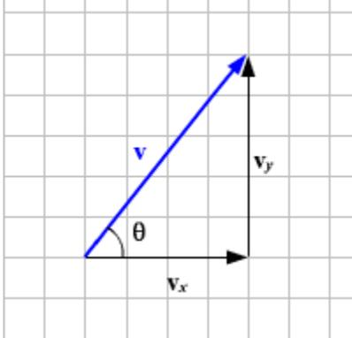
En la figura anterior, los componentes pueden leerse rápidamente. El vector en la forma componente es  $\vec{v} = \langle 4, 5 \rangle$ .
