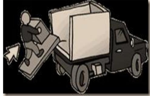
Al igual que las demás **máquinas simples** cambian fuerza por distancias. La función principal del **plano inclinado** es levantar objetos por encima de la Horizontal.
