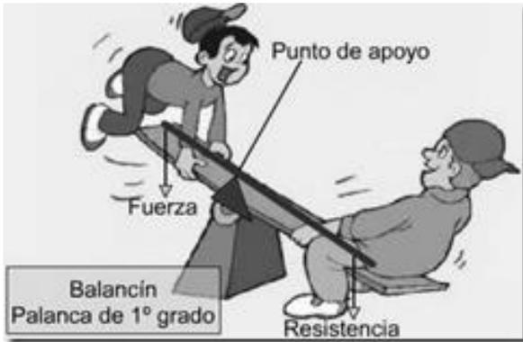
Una palanca es, en general, una barra rígida que puede girar alrededor de un punto fijo llamado punto de apoyo. La fuerza que se aplica se suele denominar fuerza motriz o potencia y la fuerza que se vence se denomina fuerza resistente, carga o resistencia.
