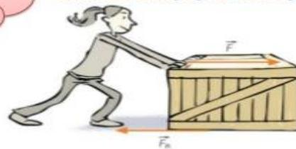
**La fuerza de rozamiento o fricción** es la que se opone al deslizamiento de un cuerpo sobre una superficie y es provocada por las irregularidades microscópicas (rugosidades) de dicha superficie que están en
