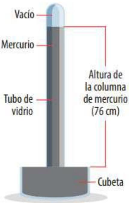
Es decir, que una columna de 76 centímetros de mercurio ejerce la misma presión que la capa de la atmósfera completa. A ese valor de presión también suele denominarse 1 atm (atmósfera) por corresponder con la presión ejercida por una atmósfera completa. 🍷
