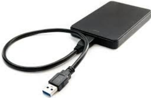
En este caso, se trata de un disco duro que se conecta al ordenador por medio de una conexión USB o SATA externa. De este modo, son ideales para guardar datos o información que no se deban utilizar todos los días o de modo constante, debido a que son dispositivos más lentos.
