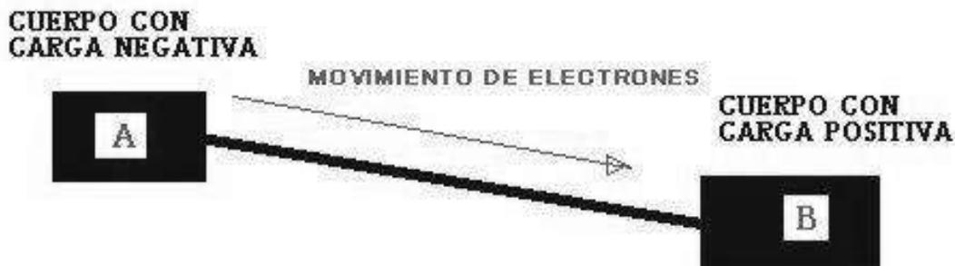
Más que pasen los electrones por el conductor, el material tiene que permitir que los electrones que forman sus átomos sean fácilmente movibles. En la imagen de arriba tenemos un cuerpo con carga negativa y otro con carga positiva (huecos) unidos por un conductor.
