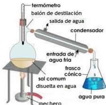
**Destilación simple:** Este método nos ayudara a fraccionar un sistema homogéneo cuyos componentes tengan puntos de ebullición diferentes. Por ejemplo, podemos usar el método de destilación si queremos fraccionar agua salada en sus componentes, agua y sal, ya que el agua tiene punto de ebullición  $100^{\circ}\text{C}$  y la sal tiene un punto de ebullición de aproximadamente  $1700^{\circ}\text{C}$ .
