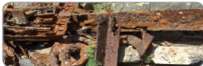
Figura 4. Hierro oxidado. Proceso de cambio químico
