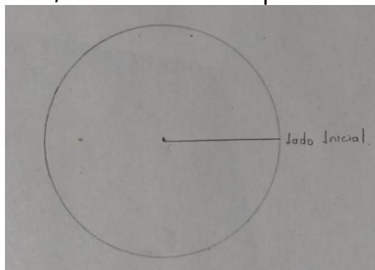
**Paso 4,** con este lado inicial, se coloca el transportador ubicando el centro de la circunferencia y se marca en  $90^\circ$
