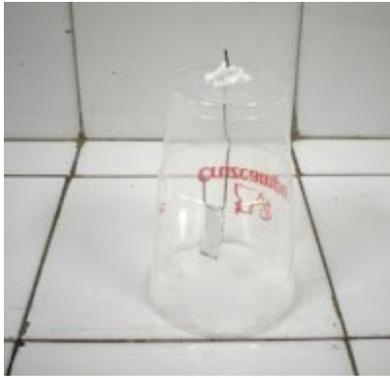
b. Engancha el clip a la base del vaso plástico (ver figura 2), y con anime o corcho blanco sujeta el clip a la base del vaso plástico. Listo! Tenemos un electroscopio.
