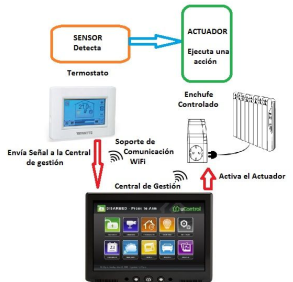
ESQUEMA ELEMENTOS INSTALACIÓN DOMÓTICA
