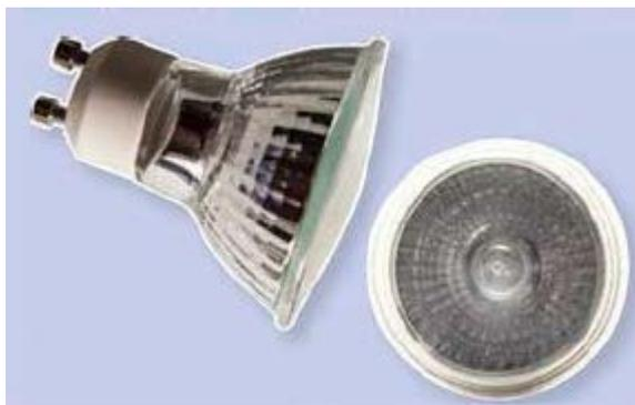
Esta bombilla utiliza el filamento de tungsteno, pero el recipiente contiene un gas halógeno. Este gas retrasa el desgaste del filamento y alarga la vida de estas bombillas. Así mismo, permite que trabajen a mayor temperatura. Gracias a estas temperaturas más elevadas, proporcionan una luz más blanca, pero también emiten radiaciones UV. Es por ese motivo por el que los fabricantes incluyen filtros en los cristales.
