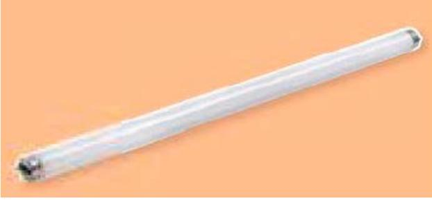
Es un tubo o bulbo fino de cristal recubierto interiormente con distintas sustancias químicas derivadas del fósforo. Estos componentes son los que emiten luz al ser irradiados por una radiación UV. El tubo contiene una pequeña cantidad de vapor de mercurio y un gas inerte, argón o neón, a una presión más baja que la presión atmosférica. En cada extremo hay un filamento de
