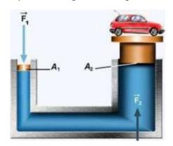
En la imagen tenemos un coche de 1000 kg encima de un disco con un radio de 2 metros y por otro lado tenemos otro disco de 0.5 metros y luego el depósito lleno de agua.
