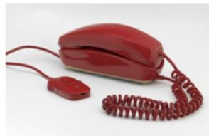
Teléfono automático de batería central (Modelo Góndola).
