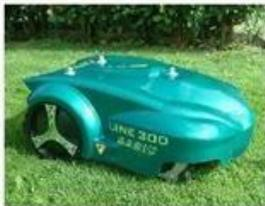
**Robots De Suelo:** Estos robots están diseñados para operar en la superficie de la tierra o de otro planeta, y por lo general se clasifican por su forma de transmisión del movimiento: ruedas, pistas o piernas.
