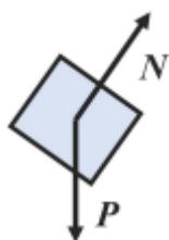
Donde  $N$  corresponde a la fuerza normal dada por la interacción entre el plano inclinado y el bloque, es por ello que la normal es perpendicular al plano inclinado. El peso del bloque,  $P$ , apunta hacia abajo. Para las ecuaciones de equilibrio es necesario descomponer el peso por sus componentes en el eje  $x$  e  $Y$ . Sea  $P_x$  el componente en  $x$  del peso
