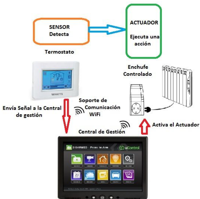
ESQUEMA ELEMENTOS INSTALACIÓN DOMÓTICA
