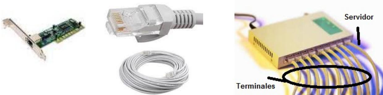
Si queremos conectar una red de computadores LAN a internet, para que todos los terminales tengan internet contratando solo una conexión, necesitaremos un router conectado al switch de la red. Como lo muestra la imagen:
