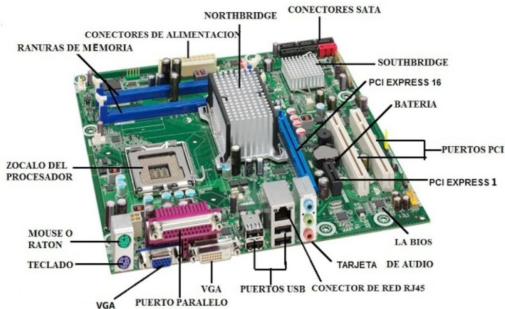
La tarjeta madre, placa base o motherboard es una tarjeta de circuito impreso que permite la integración de todos los componentes de una computadora. Para esto, cuenta con un software básico conocido como BIOS, que le permite cumplir con sus funciones.
