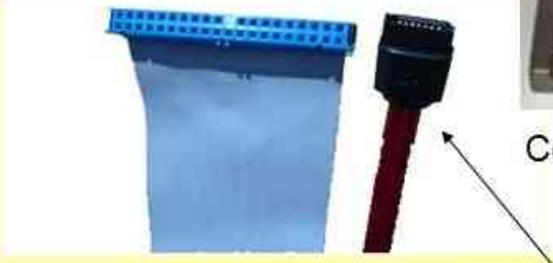
Cable Parallel ATA (izquierda 80hilos) y Serial ATA (derecha)
