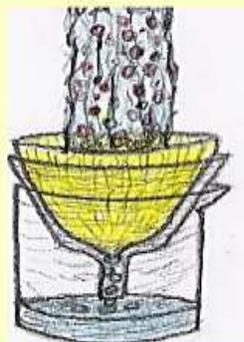
Para separar un **sólido** mezclado con un **líquido** en el cual no es soluble. El filtro permite el paso del líquido y retiene las partículas sólidas.
