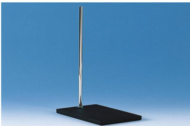
El soporte universal Suele ser de metal, constituido por una larga varilla enroscada en una base. A él se sujetan los recipientes que se necesitan para .realizar los montajes experimentales.
