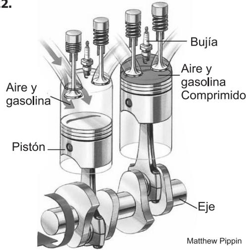
En el interior de cada pistón del motor de un carro, la gasolina mezclada con aire hace explosión cuando salta la chispa eléctrica en la bujía. La explosión produce gases en expansión que mueven el pistón ¿Cuál es la secuencia que mejor describe las transformaciones de energía en el pistón? (la flecha significa: se transforma en)
