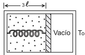
El dispositivo indicado en la figura consta de una caja dividida en dos partes por un émbolo sin fricción. En el compartimiento de la izquierda hay  $n$  moles de gas ideal y un resorte de constante  $K$  y longitud natural  $l$  que sujeta el émbolo permaneciendo elongado en equilibrio, como se muestra.
