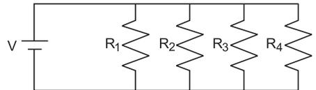
Las resistencias  $R_1$ ,  $R_2$ ,  $R_3$  y  $R_4$  de cada uno de los carros son iguales, y su valor es  $R$ . La pista está alimentada por una pila que entrega un voltaje  $V$ . La pista con los carros en movimiento se representa mediante el esquema simplificado del circuito eléctrico mostrado en la figura.
