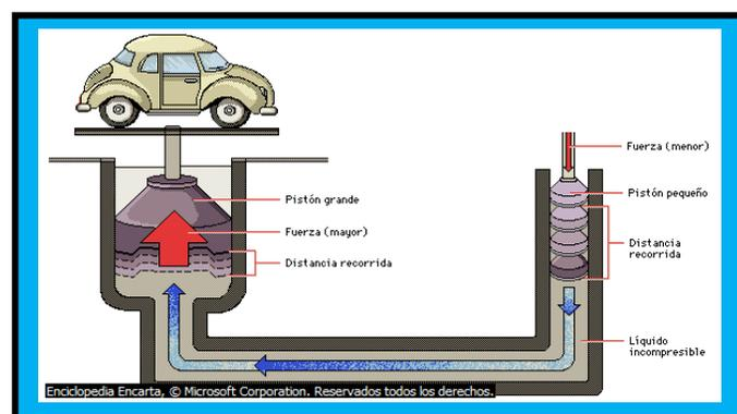
El principio de Pascal tiene su principal aplicación en la prensa hidráulica, que sirve para multiplicar la fuerza ejercida sobre un embolo de un cilindro lleno de un líquido que se comunica a otro cilindro provisto de un embolo de área mayor.
